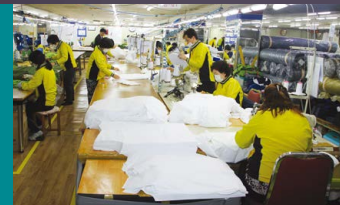
2단계 : 중량체크,재단 Weight Check, cutting
